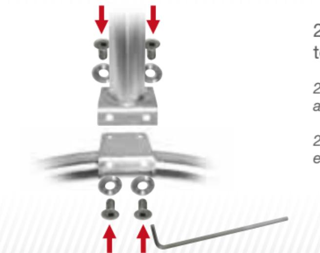
2. Befestigen Sie mittels Winkelschraubendreher die Fußteile mit den Scheiben und Schrauben an den Rundbogen.
